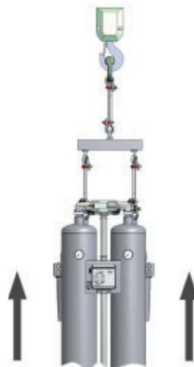
II: Ustavení jeřábem
